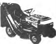
MURRAY 31720. 12 HK B&S motor. 76 cm klippebredde og sideutkast. Oppsamler er ekstra utstyr.
